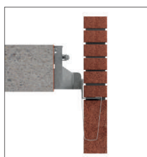
Onzichtbaar met verschillende types rollaagbeugels
