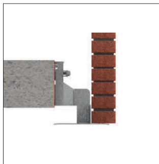
Spouwafsluiting met T-profiel
